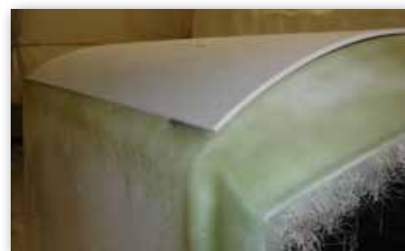
Isolation en mousse polyuréthane (épaisseur 10 mm) fixée entre deux couches de polyester
