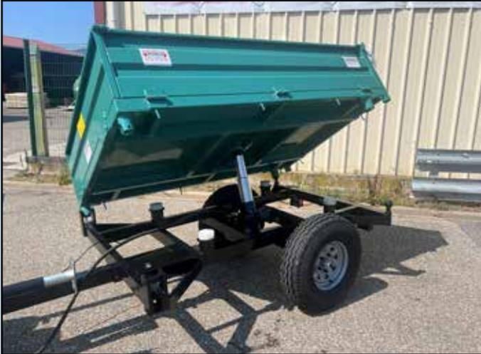
Vérin sur rotule pour le basculement latéral et longitudinal
