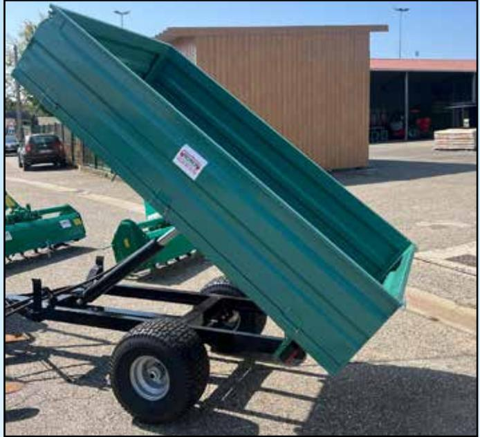
Bascule longitudinale de la benne
