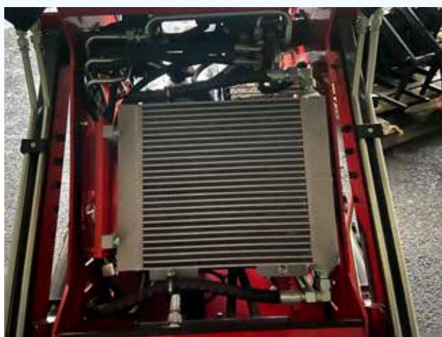
Radiateur eau de refroidissement
