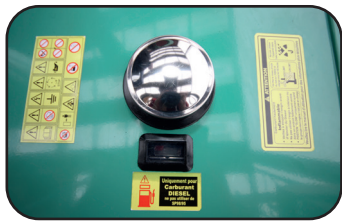
Réservoir à carburant avec jauge de niveau
